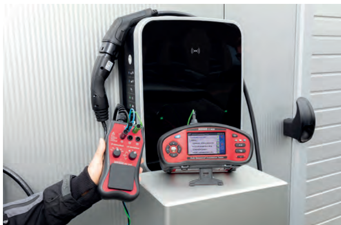
Normkonforme Prüfung von EV-Ladestationen (Wallbox) der Ladebetriebsart 3 (BENNING IT 200 (044106) mit optionalen Prüfadapter BENNING EV 3-2 (044169))
