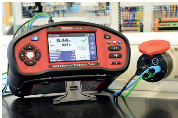
Schleifenimpedanzmessung an 5-poliger CEE-Steckdose (BENNING IT 200 (044106) mit dem optionalen Messadapter BENNING TA 7-16 (044040))
