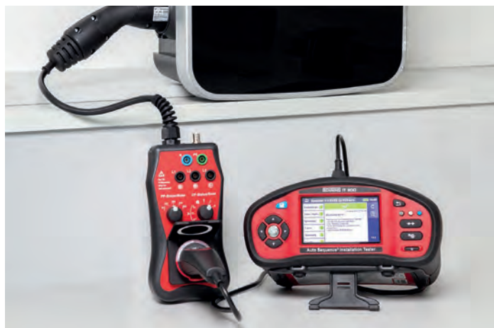
Normkonforme Prüfung von EV-Ladestationen (Wallbox) der Ladebetriebsart 3 (BENNING IT 200 (044106) mit optionalen Prüfadapter BENNING EV 3-2 (044169))
