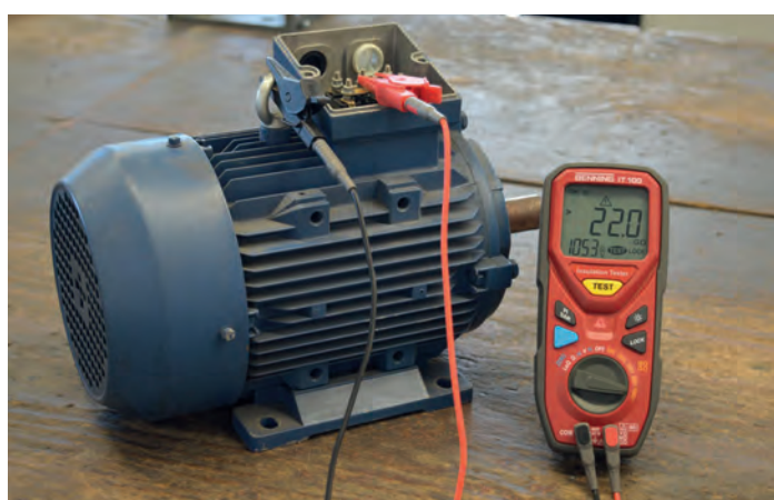
Isolationswiderstandsmessung eines Motors (BENNING IT 100 (044107))
