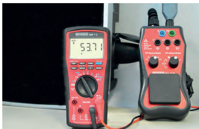
Tastverhältnismessung des CP-Steuersignals einer Wallbox
