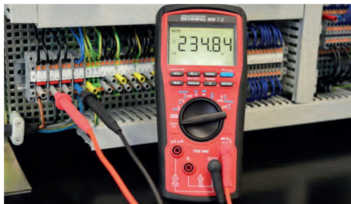
Netzspannungsmessung mit LoZ- und Auto-V-Funktion
