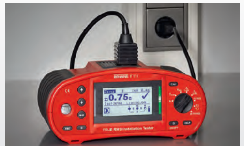
IT 115 bei der Schleifenimpedanzmessung ohne RCD-Auslösung
