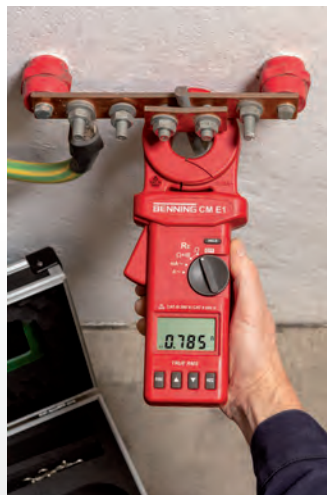
Messung des Erdschleifenwiderstandes eines Anlagenerders
