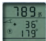
Solare Einstrahlung, Neigungswinkel und Kompasspeilung
